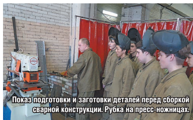
Показ подготовки и заготовки деталей перед сборкой сварной конструкции. Рубка на гильотине.
