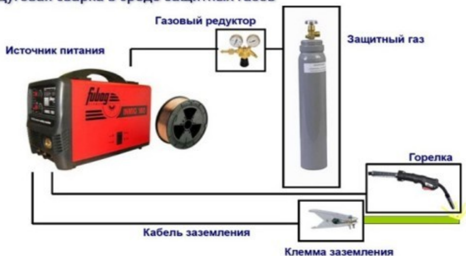
Рисунок 1. Дуговая сварка в среде защитных газов.
