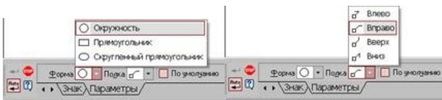
Рис. 103 Выбор формы контура Рис.104 Выбор направления полки
