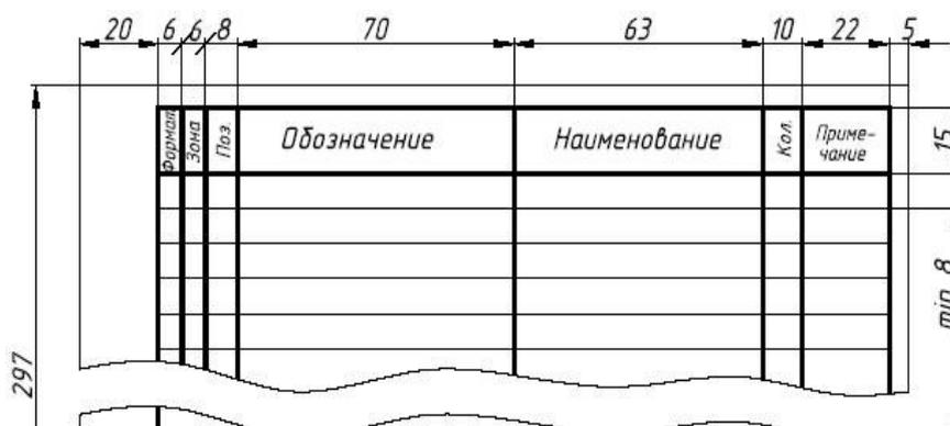
Если сборочный чертеж размещен на листе формата А4, спецификацию совмещают со сборочным чертежом.
