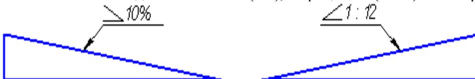
Уклон используется, например, при изготовлении фасонного проката: швеллеров, двутавров, тавровых профилей и т.п.
