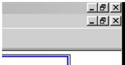
Рис.5 Кнопки управления состоянием окна
