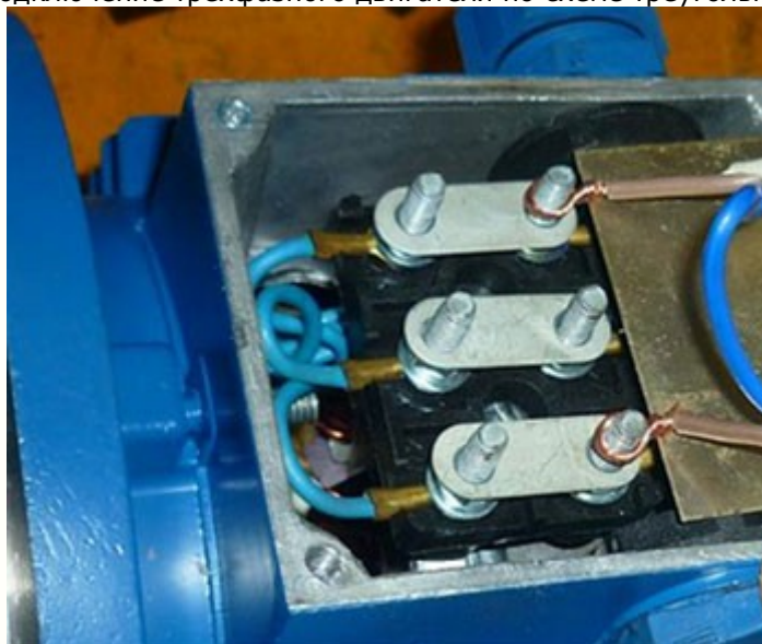
Подключение трехфазного двигателя по схеме треугольник
