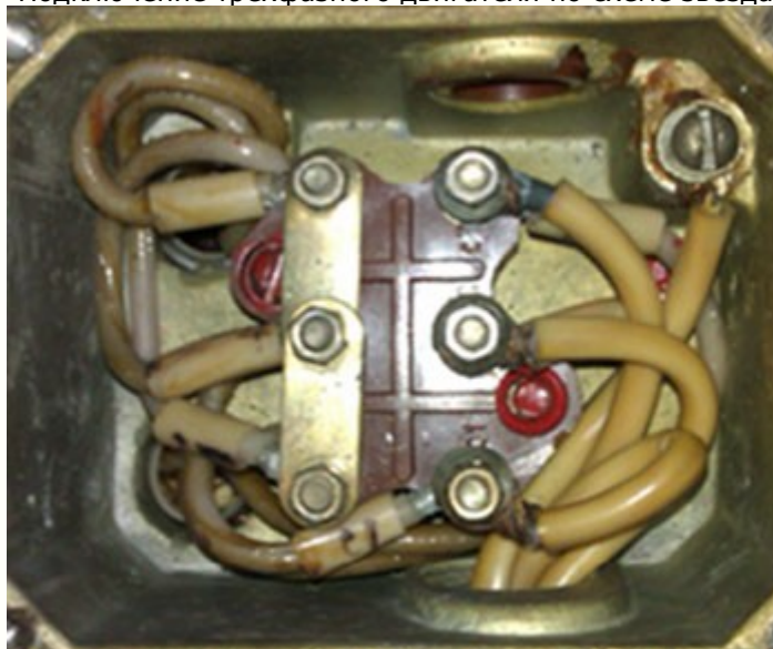
Распределительная коробка трехфазного двигателя с положением перемычек для подключения по схеме звезда
