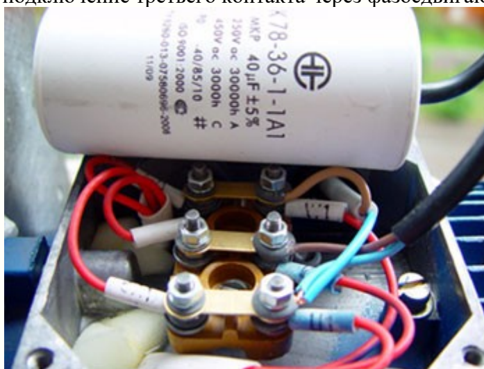
Подключение трехфазного двигателя к однофазной сети
