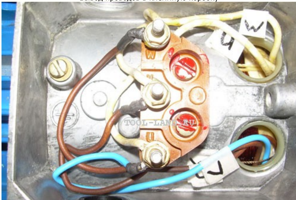
Подключение проводов к клеммной колодке
