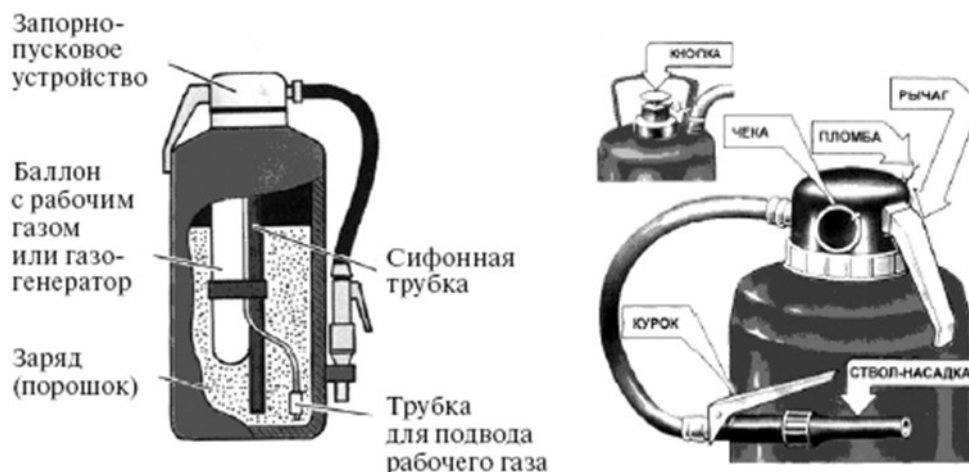
Рис. 26. Порошковый огнетушитель со встроенным газовым источником давления ОП-5
