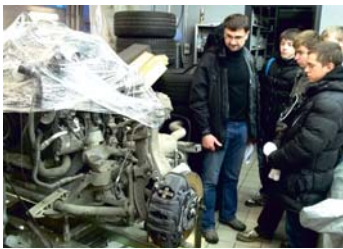
Детальный осмотр снятого с автомобиля Porsche Cayenne двигателя в сборе с трансмиссией
